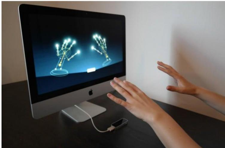
FIGURA 8 - LA MODELLAZIONE DELLE MANI E DELLE DITA MEDIANTE LEAP MOTION.
