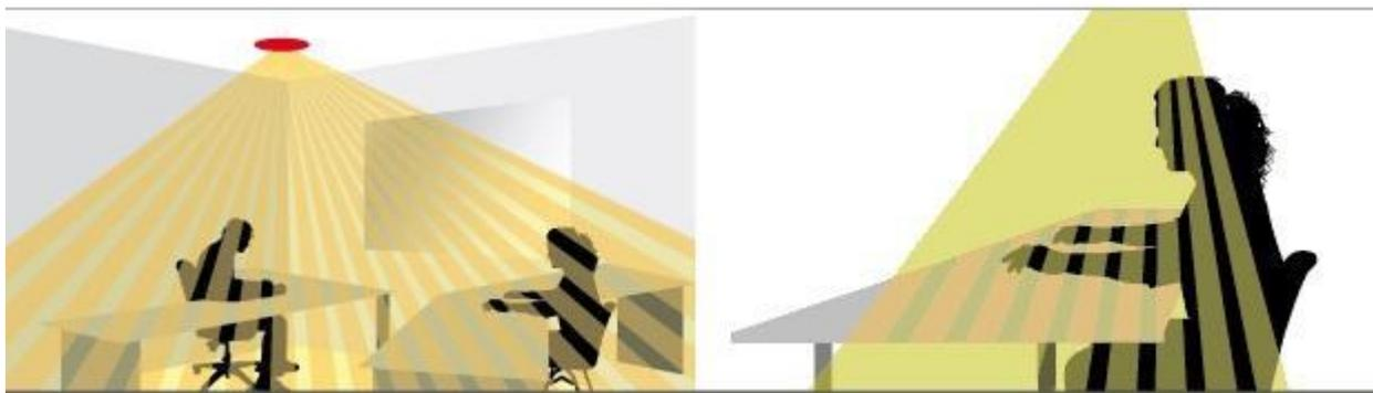
FIGURA 83 - COPERTURA DI UN SENSORE PIR
