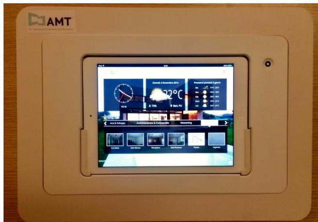
FIGURA 89 – ESEMPIO DI DISPOSITIVO TATTILE DI INTERAZIONE CON IL SISTEMA DOMOTICO
